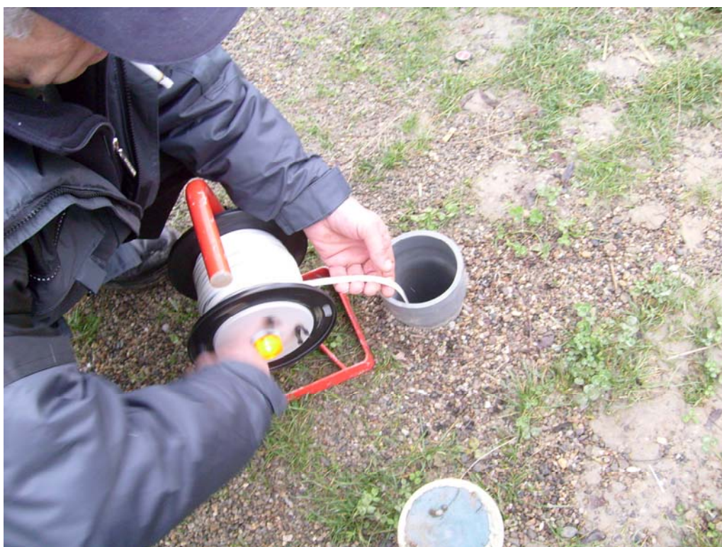
Слика 4 Пиезометар Јурумлери
